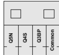
**注:** 外部旁路柜的连接电缆未受电（尺寸最大为2.5 mm<sup>2</sup>）。
