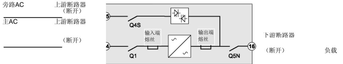
在确定上游断路器的规格时，必须考虑以下参数：UPS输入端及输出端熔丝的时间/电流曲线：
