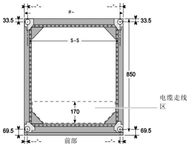
机柜四个地脚为圆柱形，直径40mm。
