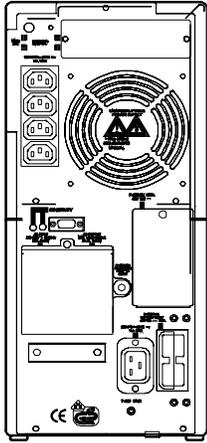
SU5000UXI 型不间断电源不带内置电池组。不间断电源上外置电池组的接线端子位置请参见左图。电池组上的接线端子用不同的颜色加以区别：48Vdc UXBP48M 型电池组的接线端子为蓝色。为防止接线错误，电池组的接线端子亦有识别标号。
