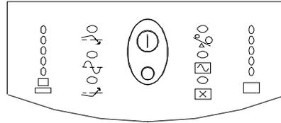
① 在插好不间断电源的电源插销后，按下上方的大 on/test 按钮，然后松开，向负荷设备供电。这时负荷设备立即获得电力，同时不间断电源发出“哗哗”声并进行自检。
