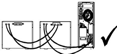
UXI 型不间断电源安装两个电池组的正确安装方法。
